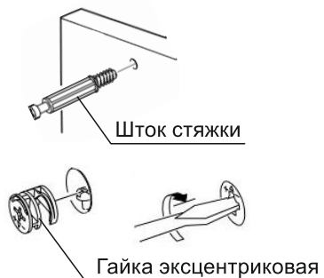
Схема 3. Установка стяжки эксцентриковой
